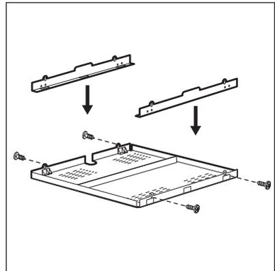
Wenn Sie einen Schutzkasten (optionales Zubehör) verwenden, ist der Schutzboden direkt unter dem Kochfeld nicht erforderlich. Das Schutzkasten Zubehör ist möglicherweise in einigen Ländern nicht erhältlich. Wenden Sie sich an den Kundendienst-Service.
