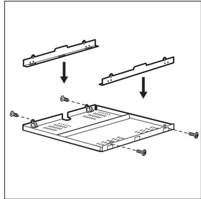
Jos käytössä on suojakotelo (lisävaruste), keittotason alapuolella oleva suojatase ei ole tarpeen. Suojakotelolisävarustetta ei välttämättä ole saatavissa kaikissa maissa. Ota yhteys asiakastukipalveluun.
