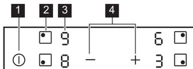
Använd touchkontrollerna för att använda produkten. Displayerna, indikeringarna och ljudsignalerna markerar vilka funktioner som är aktiverade.
