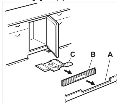
2. Reinigen Sie das Lüftungsgitter.
